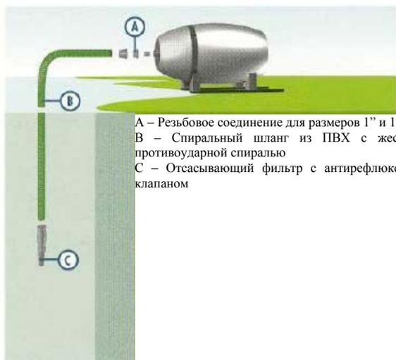
А – Резьбовое соединение для размеров 1" и 1" 1/4
