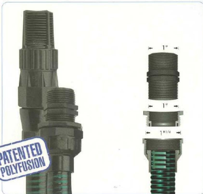
Вытяжной набор для соединения к насосам с арматурой 1" и 1" 1/4. Aspirflex является запатентованным изделием: благодаря определенной системе соединения в polyfusion между шлангом и арматурой, исключая возможность поломки или утечки воды. Зеленый спиральный шланг **поставляется вместе с арматурой и пластиковым отсосом с фильтром.**
