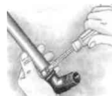
Сборка полиэтиленовой трубы: 2. Затяните зажим вокруг трубы и фитинга.
