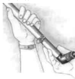
Сборка полиэтиленовой трубы: 1. Установите зажим на трубе, затем введите в нее завершенный фитинг.
